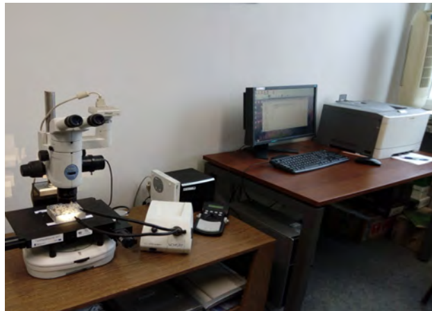
Phot. 2. The setup for air pore structure testing Fot. 2. Zestaw do badania struktury porów powietrznych
